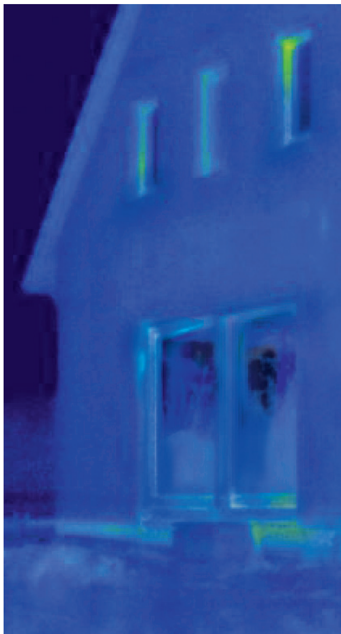
După renovare: Prin utilizarea ușii culisante cu ridicare în plan paralel GENE0, pierderile de căldură se reduc vizibil.
