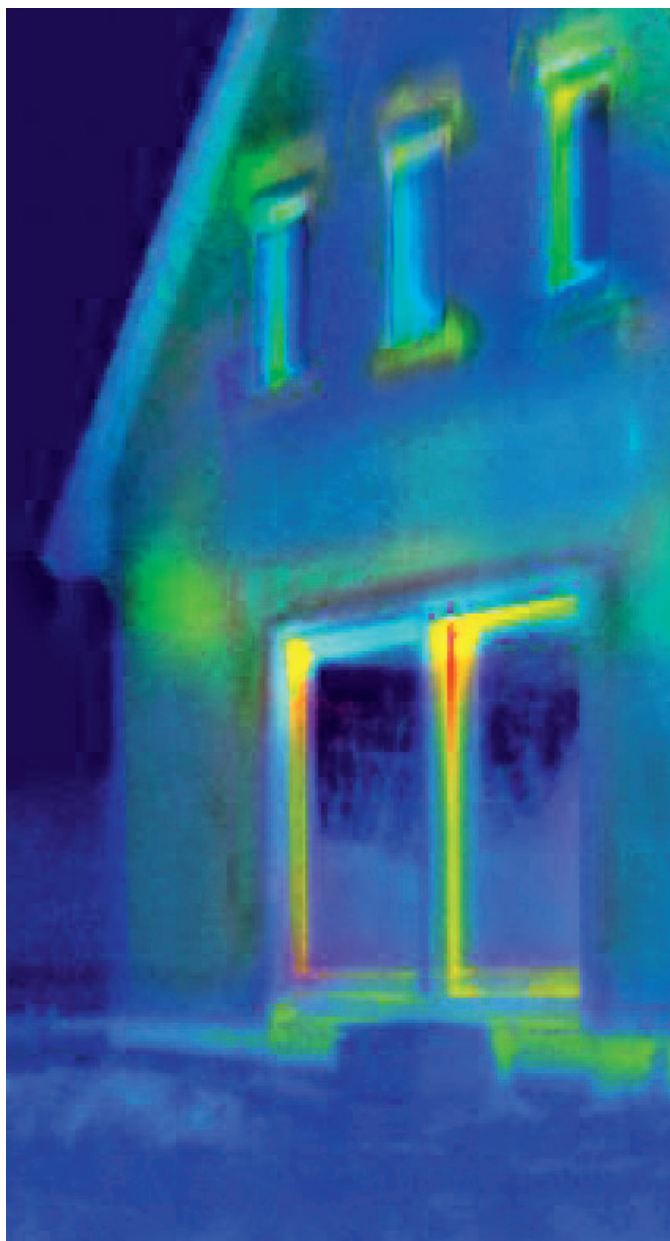
Înainte de renovare: Pierderile mari de căldură sunt reprezentate cu roșu în imagine.
