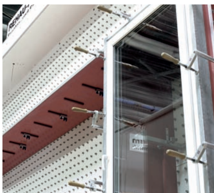
Echipament de testare pentru presiunea vântului
