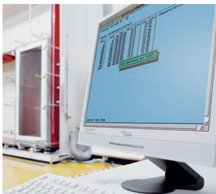
Testarea etanșeității la ploaia torențială
