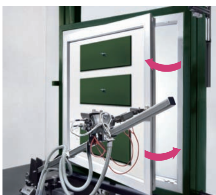
Echipament pentru testarea ferestrelor la solicitări intense
